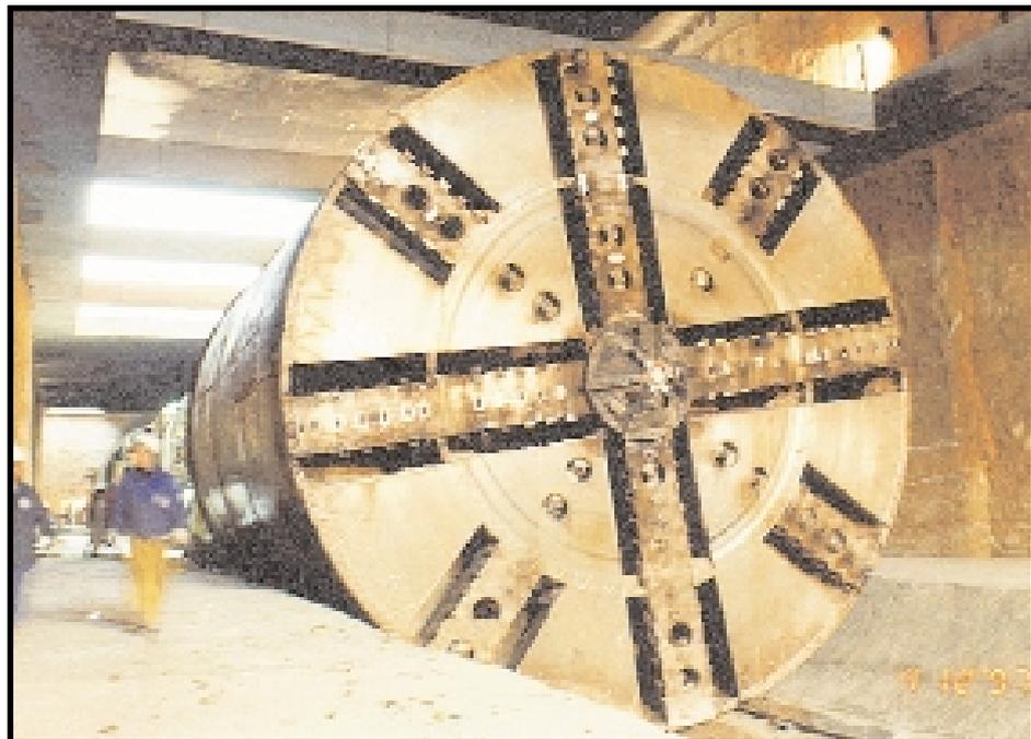
Los escudos de las tuneladoras pueden ser abiertos o cerrados. Las tuneladoras de escudo cerrado, son las máquina más seguras que actualmente existen para los trabajadores que excavan un túnel, pues en caso de que fallara la sustentación de la bóveda ya excavada o el frente de excavación (el frente es lo realmente más problemático, pues es muy inestable), los trabajadores se encontrarían bien protegidos en su interior.
